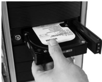
4. Asegure el disco en la montura, continuando el cierre del brazo de la cerradura (*locking arm*). Suavemente, aplique presión sobre el brazo de la cerradura, hasta que escuche el 'clic' de la cerradura de resorte (*spring lock*).
