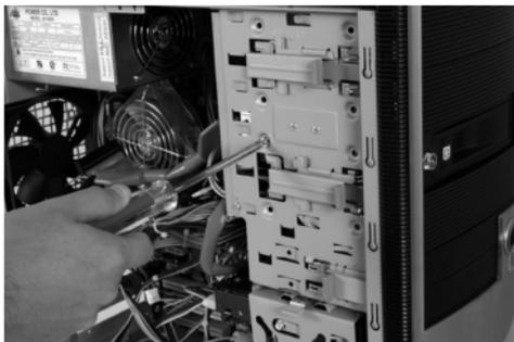
5. Conecte el cable de poder SATA y los cables de datos SATA a los puertos apropiados, ubicados en la parte trasera del panel posterior de la montura del disco (drive frame).
