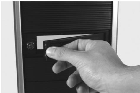
2. Posicione el disco duro cerca de la entrada de la montura, con la etiqueta del disco duro viendo hacia arriba y el panel trasero del disco duro viendo hacia el interior de la computadora.
