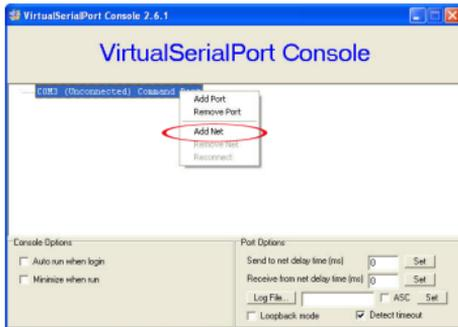
8. Das "Add Net" Fenster ermöglicht Ihnen die Konfiguration des COM-Port zu den Einstellungen, die von der NETRS2321E-Einheit verwendet werden, welche Sie zuordnen möchten. Wählen Sie die richtige Betriebsart und Netzwerkeinstellungen, die Sie für die Konfiguration des NETRS2321E benutzt haben (siehe Konfiguration der Web-Konsole).
