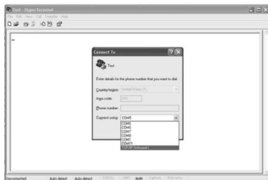
必要な設定を行ったら、「OK」をクリックします。ハイパーターミナル画面が表示されます - すべての設定が正しく行われていれば、ターミナルが面の左下にある時計に「接続状態」と表示され、hh:mm:ss形式のタイマーがカウントし始めます。
