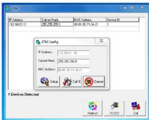
NETRS2321Eに割り当てられたIPアドレスを設定するには、利用可能なデバイスを左クリックすると、画面が開きます。お使いのコンピュータと同じサブネットマスクを持つIPアドレスを割り当てます。割り当てたアドレスがネットワーク上ですでに使用されているものではないことを確認してください。「OK」ボタンを押すと、IPアドレスが2~3秒以内に更新されます。
