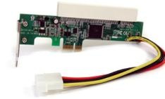
1. Stecken Sie die Low-Profile-PCI-Karte in den weißen PCI-Steckplatz-Anschluss oben auf der Adapterkarte.
