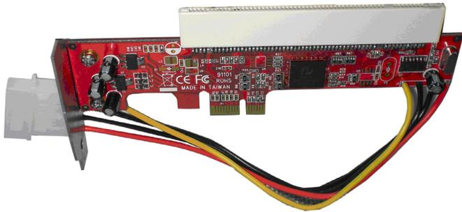
Nota: Si se utiliza el bracket de repuesto PCIe, debe retirarse primeramente el bracket de la tarjeta PCI. Las tarjetas PCI standard pueden no ser adecuadas para el sistema.
