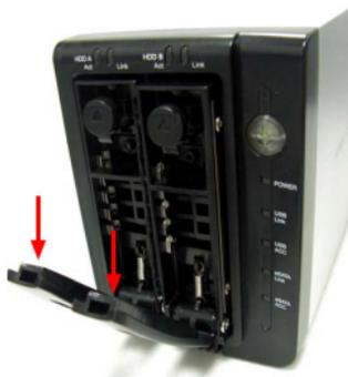
2. Récupérez les vis de fixation retenues dans les accroches plastique, puis fixez le disque dur dans les supports avec les vis retirées précédemment. Répétez l'opération pour chaque plateau de disque dur.
