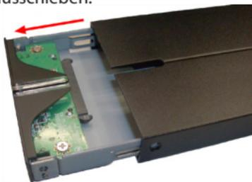
3. Legen Sie das 2,5" SATA-Laufwerk mit Abstand zu den Anschlüssen, in das Festplatten-Tray. Schieben Sie die SATA-Festplatte auf den SATA-Laufwerksanschluss, bis sie fest verbunden ist.
