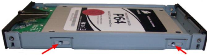
5. Schieben Sie das Festplatten-Tray zurück in das Gehäuse. Stellen Sie sicher, dass die LED auf dem Festplatten-Tray mit dem LED-Ausschnitt des Gehäuses ausgerichtet ist.
