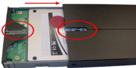
6. Befestigen Sie mit den in Schritt 1 entfernten Schrauben das Festplatten-Tray im Gehäuse.
