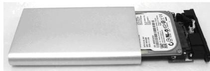
4. Deslice el disco duro con el panel trasero instalado en la carcasa de metal
