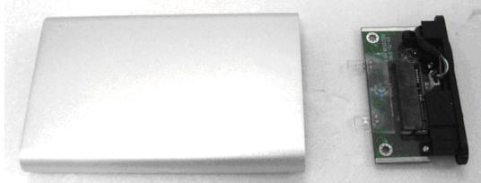
2. Conecte el disco duro al panel trasero, simplemente deslizándolo en el conector SATA 7+15 del panel
