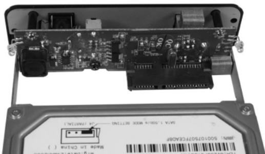
3. Mit der Festplatte an der Vorderseite angeschlossen, drehen Sie das Laufwerk um auf seine Unterseite. Befestigen Sie die Festplatte an den Frontpanel-Schienen auf beiden Seiten, mit Hilfe der beiliegenden Schrauben (2):
