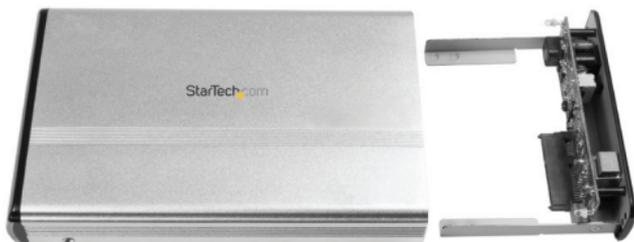
2. Positionieren Sie die Festplatte die Sie installieren möchten so dass der SATA Anschluss in Richtung SATA Schnittstelle an der Front des Gehäuses zeigt.
