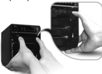
4. Retire los insertos de cartón (si es la primera vez que se realiza esta instalación) y después inserte los discos duros en las ranuras. Si está instalando menos de cuatro unidades de disco, asegúrese de que haya un disco instalado en la primera ranura de abajo. Esto ayudará cuando se reinstale la jaula metálica. Los discos duros pueden ser retirados del gabinete, presionando las asas hacia abajo y después jalándolas hacia afuera.
