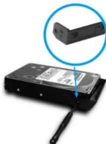
3. Une cage métallique se trouve à l'intérieur devant les baies de disque. Deux petites languettes se trouvent au dessus de la cage. Pressez les pour libérer la cage et la retirer.
