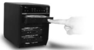
5. Une fois tous les disques durs installés, réinstallez la cage métallique et la porte avant. Veuillez vous assurer que la cage métallique reste bien dans son rail avant de replacer la porte.
