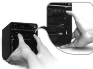
4. Retirez les cartons insérés (configuration initiale) puis insérez les disques durs dans les logements. Si vous installez moins de quatre disques durs, assurez vous d'installer un disque dur dans le logement inférieur. Cela vous aidera lors de la réinstallation de la cage métallique. Les disques dur peuvent être retirés du boîtier en abaissant leurs poignées puis en les tirant vers l'extérieur.
