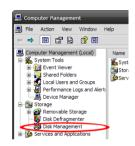
Localisez le disque listé comme "non alloué" (vérifier la capacité du disque dur afin de confirmer que c'est le bon disque dur), puis faites un clic droit dans la section "non alloué" et sélectionnez "Nouvelle partition".
