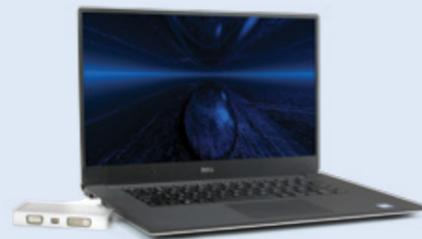
Schließen Sie an Ihren Dell XPS weitere Displays oder einen Projektor an: über den Thunderbolt 3 USB-C-Port zu VGA, HDMI, DVI, Mini-DisplayPort oder herkömmliche Thunderbolt-Technologie.
