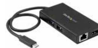
Con il nuovo **adattatore multi-porta USB-C, dotato di tecnologia Power Delivery**, puoi alimentare o ricaricare il computer laptop creando una workstation pronta all'uso. **DKT30CHPD**
