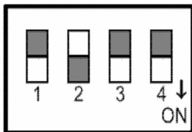
**OFF:** ピン 2がOFFの位置にある場合は、110VDSLEXT / GB / EUはインタラクティブモードで動作し、最大250msのインパルスノイズのコミュニケーションを保護し、レイテンシを6ms以下にします。
