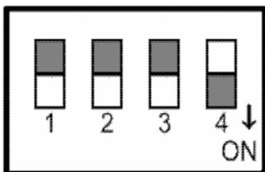
**OFF:** ピン 4がOFFの位置にある場合は、110VDSLEXT / GB / EUは最大9 dBまでのSNRで動作します。
