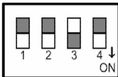
**OFF:** ピン 3がOFFの位置にある場合は、110VDSLEXT / GB / EUはシンメトリックモードで動作し、ダウンストリームおよびアップストリームデータ転送をG.997バンドプランで実行します。
