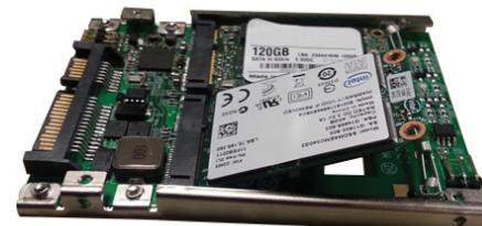
4. Presione la unidad hacia el bracket de montaje de la bahía 2, hasta que el SSD haga "clic", de esta forma señalando que está debidamente asegurado.
