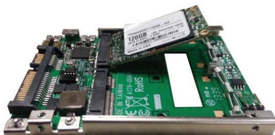
2. Presione la unidad hacia el bracket de montaje de la bahía 1, hasta que el SSD haga "clic", de esta forma señalando que está debidamente asegurado.
