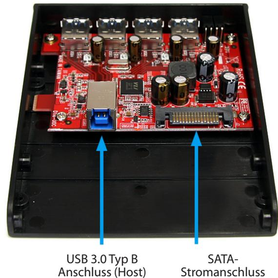
6. Verbinden Sie das USB 3.0-Kabel von der 35BAYUSB3S4 mit einem verfügbaren USB 3.0-Anschluss. Wenn keine internen Ports verfügbar sind, können Sie müssen führen Sie das Kabel außerhalb des Gehäuses und einen externen Anschluss.
