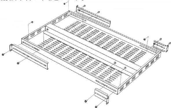
2. 8本のM5ネジ (ワッシャ付) を使って、キャビネットの取付けポストに棚板を設置します。
