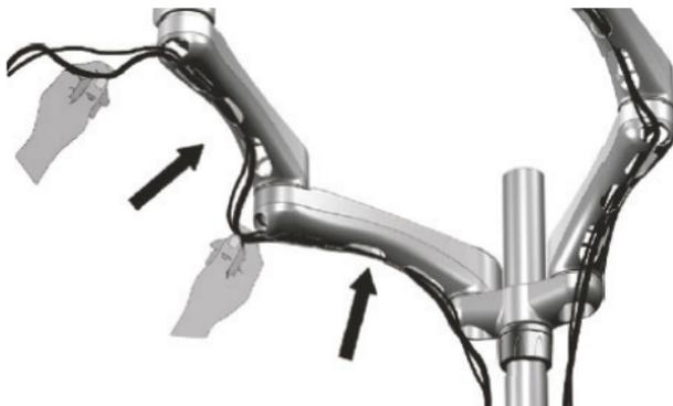
3. ケーブルクリップ(14)を使って、ディスプレイケーブルを支柱に固定します。
