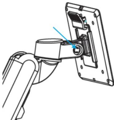
回転抵抗を増やす/減らすには、回転部のネジをプラスドライバーまたは3mmの六角 (5) レンチを使用して調整します。
