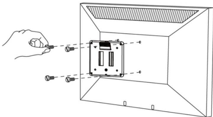
**警告:**ネジを締め過ぎないようにしてください。また、抵抗を感じたらすぐに手を止めてディスプレイが損傷しないようにしてください。すべてのネジの長さと同型であることを確認してください。
