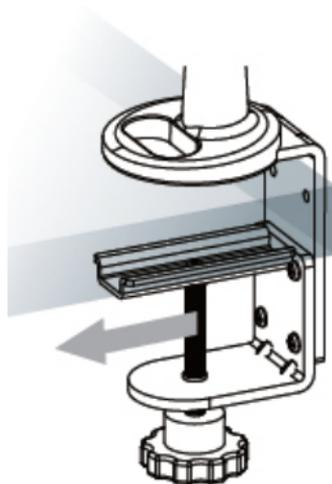
**注記:**デスククランプは、厚さ20~100 mmのデスク/テーブルに対応しています。デスク/テーブルの厚さにクランプを調節するには、下図のように4つのネジを外して底面を調節します。
