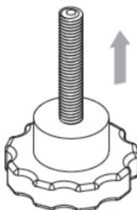
4. モニタアーム(1)のベースをグロメット穴に合わせてハンドスクリューを回して固定します。圧力プレートがデスク表面と完全に接触していることを確認してください。
