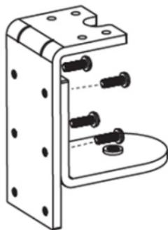
2. モニタアーム(1)をベースに挿入してベース裏面のネジを3 mm六角レンチ(5)を使用して締めます。
