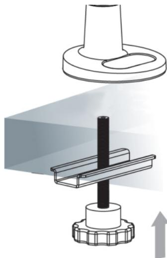
5. モニタアーム(1)をベースに挿入してベース裏面のネジを3 mm六角レンチ (5) を使用して締めます。
