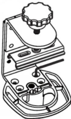
2. 圧カプレート上部のフィリップスネジと2つのワッシャーを取り外して、ハンドスクリューをクランプから外します。
