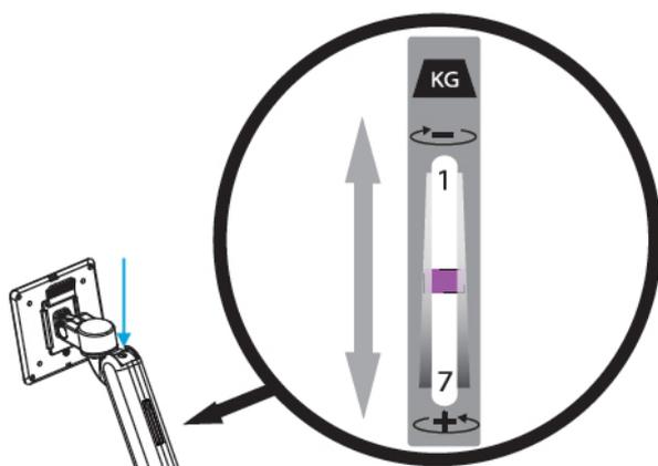
傾き抵抗を増やす/減らすには、取付用金具結合部側面のネジを6 mmの六角 (4) レンチを使用して調整します。
