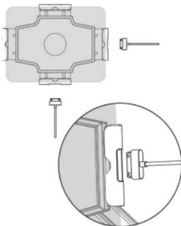
2. マウントアームに沿ってケーブルを配線し、希望の位置でクリップ(#3)でケーブルをマウントアームに固定します。
