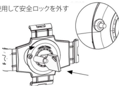
2. タブレットマウント背面の黄色のタブを右側へ移動させ、位置固定のロックを外します。
