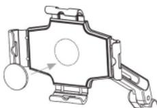
5. タブレットマウント背面の黄色のタブを左側へ移動させ、位置固定のロックをかけます。
