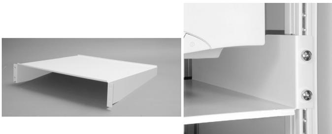
2. ディープシェルフ - ディープシェルフをキャビネットに取り付ける前に、同梱のネジとナットを使って、まず、取付用ブラケットをシェルフに取付けなければなりません。キャビネットのナットを希望の高さに動かし、シェルフのブラケットをフロントポストとリアポストに固定します。
