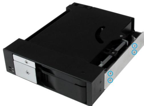
3. Ajuste los 4 tornillos incluidos en la caja, en las perforaciones de instalación de la bahía de 5.25", atornillándolos a la unidad HSB2535SATBK fijándola en el sitio.
