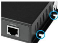
2. Selon la surface de montage, utiliser les outils appropriés pour installer, dans le mur, les vis inclus dans l'emballage. Laissez un espace d'environ 2 mm entre la tête de la vis et la surface du mur.
