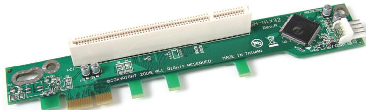
4. Sans forcer, insérez la carte dans l'emplacement vide, en vous assurant qu'elle soit fermement connectée. Fixez la carte sur le support de montage de carte adaptatrice de connexion (riser card) sur le boîtier de l'ordinateur (reportez-vous à la documentation du système informatique, si nécessaire).
