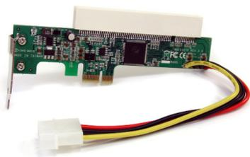
1. ロープロファイルのPCIカードをアダプタカード上部の白いPCIスロットコネクタに挿入します。
