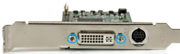
2. プラスドライバー (別売) を使って回路基板上のDVIポート内側に隣接しているネジを取り外します。
