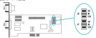
このカードは、パワー・オーバ・シリアルをサポートしているデバイスで使われるDB9コネクタの9番目のピンから電力出力を行うために設計されました。このカードを使うことにより、ユーザは各ポートに5V、12V、R(電源なし)を設定することができます。また、LP4電源コネクタを接続することにより、システム電源から必要な電力を得るすることもできます。
