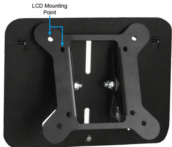
3. Monte la placa posterior en un rack de 19" de ancho y ajústela con los tornillos y tuercas M5 incluidas con el producto. El extremo con bisagras posee dos agujeros de montaje y los tornillos de bloqueo colocados en el extremo opuesto deben ajustarse con tuercas M5.
