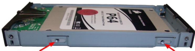
5. Réinsérez le tiroir disque dans le boîtier. Assurez-vous que la LED sur le tiroir disque soit alignée avec la découpe du boîtier censé laisser apparaître la LED.
