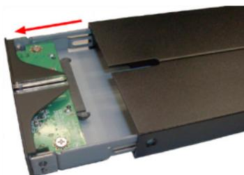
3. Insérez le disque SATA 2,5" dans le tiroir disque le plus éloigné des connecteurs. Faites glisser le disque SATA vers le connecteur de disque dur SATA jusqu'à ce qu'il soit fermement connecté.
