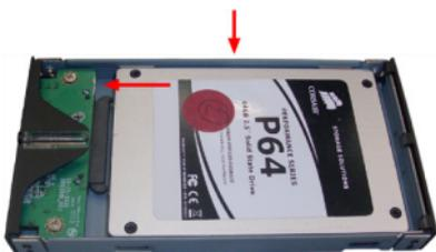
4. Utilisez les vis de fixation du disque fournies pour fixer le disque au tiroir. Utilisez 2 vis de chaque côté du disque SATA.
