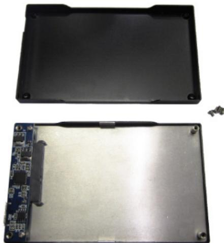
2. Placez le disque SATA 2.5" dans la moitié contenant le connecteur SATA et faites glisser le disque sur le connecteur SATA.
