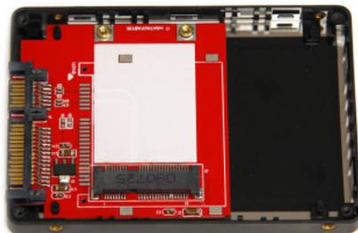
2. Insérez le disque mSATA dans le connecteur à angle. Assurez-vous de bien aligner l'encoche dans le connecteur avec l'encoche sur le connecteur du disque mSATA.
