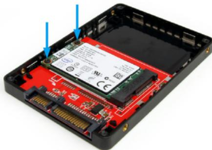
4. パネルをエンクロージャに戻し、4本のネジを締めます。
