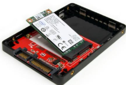
3. mSATAドライブをスロットにしっかりと挿入したら、ドライブの背面をアダプタボードのほうに押します。mSATAドライブを同梱の取り付け小ネジでボードに固定
