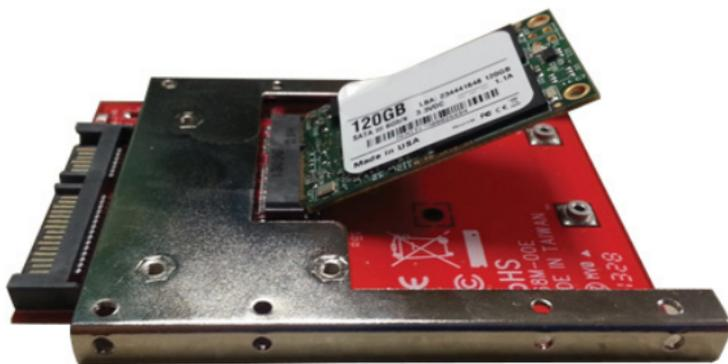
2. ドライブをドライブ取付用金具側へ押し下げます。次に、SSDドライブの取付用穴にネジセットの小型ネジ2本を通し、プラスドライバ(非付属品)で締めてドライブ取付用金具を固定します。
