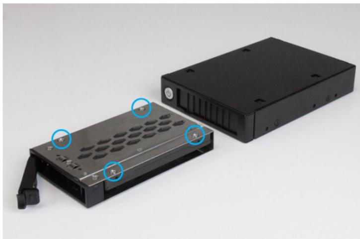
3. HDDをインストールしたドライブトレイをスライドしてスロットに戻し、ドアを閉めます。
