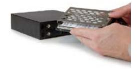
4. HDDをインストールしたドライブトレイをスライドしてスロットに戻し、ドアを閉めます。
