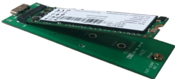
f. ドライブをドライブ取付用スタンドオフ側へ押しします。次に、SSDドライブの取付用穴に取り外したネジを通し、プラスドライバーで締めてドライブ取付用スタンドオフを固定します。
