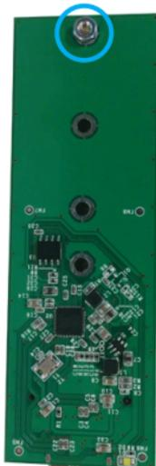
c. (ドライブ取付用金具の移動が必要な場合のみ) お使いのSSDに適合するドライブ取付用穴にドライブ取付用スタンドオフを取付け直します。小型ペンチまたは5mmナットドライバ(非付属品)で背面にあるスタンドオフを固定しているナットを外します。
