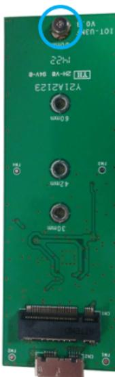
**注意:** M.2 SSD上のコネクタは、ドライブが一方のみにフィットするように加工されています。
