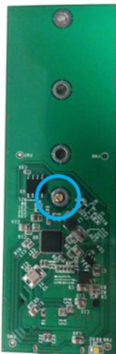
d. 付属のドライバでドライブ取付用スタンドオフを固定しているネジを取り外します。
