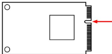
2. Miniカードをシステムボードに押し付け、Miniカードの上端をシステムボードに固定します。
