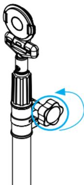
4. 三脚ポールを上下に動かして希望する高さにし、三脚のつまみネジを右に回して締めます。
