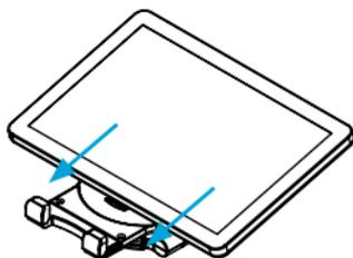
2. もう一方の格納式ブラケットを引き出して開け、ブラケットのツメをタブレットのもう一方のサイドにかぶせます。ブラケットをゆっくり放します。
