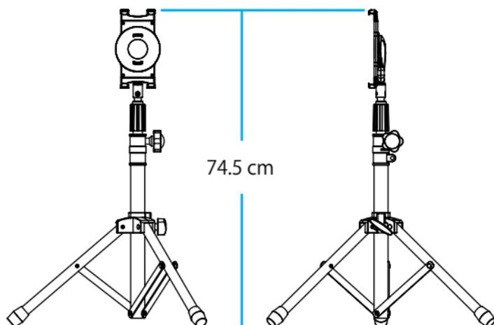
延長してタブレットホルダを取り付けた時の三脚の外形寸法
