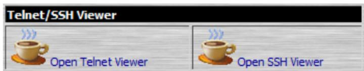
Ces visionneuses permettent aux utilisateurs d’ouvrir une session Telnet ou SSH pour le SV1108IPEXT/POW, à partir du navigateur. Selon les autorisations de l'utilisateur, le lien visionneuse Telnet ou le lien “SSH Viewer”, ou les deux sont montrés.
