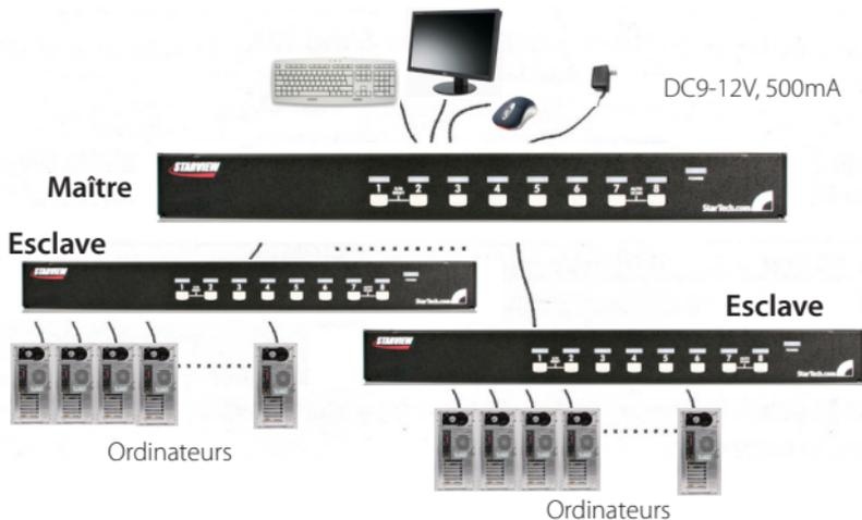
**NOTE:** Un appareil (ordinateur ou commutateur KVM) sur tout port PC peut être modifié à tout moment après la première mise sous tension. Si vous modifiez l'une des connexions de port PC 1 à PC 8 à partir d'un ordinateur sur un commutateur KVM Esclave ou vice versa, ou que vous remplacez/changez le périphérique, l'OSD sera mis à jour la prochaine fois que le menu OSD est activé.
