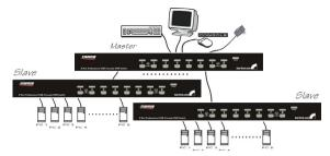
El número máximo de computadoras controladas por una configuración Máster/ Esclavo con unidades, todas, de 16-puertos es 136, con 8 unidades de Esclavos de 16-puertos (a PC 1 - PC 8) y cada Esclavo conectado a 16 computadoras, más 8 computadoras más conectadas directamente al Máster (a puertos PC A - PC H):
