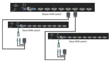
El número máximo de computadoras controladas por una configuración Máster/ Esclavo con unidades, todas, de 8-puertos es 64, con 8 Esclavos y cada Esclavo conectado a 8 computadoras:
