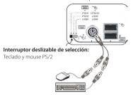
Teclado PS/2 y mouse USB: Deslice el interruptor a la posición central
