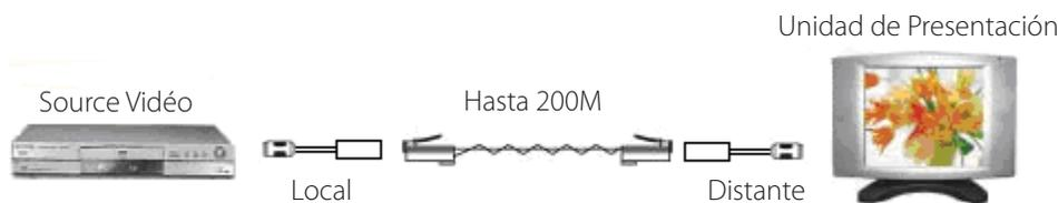
1. Conecte el cable de S-Video incluido al puerto de salida ubicado en la parte posterior del dispositivo que utilizará como fuente de video.
