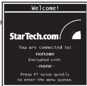
Lorsque vous vous connectez au système, une fenêtre de bienvenue s'affiche, indiquant le système que vous contrôlez, l'algorithme de chiffrement utilisé, et la force clé actuellement en vigueur. Cliquez n'importe où dans la fenêtre pour la désactiver, ou attendez dix secondes.
