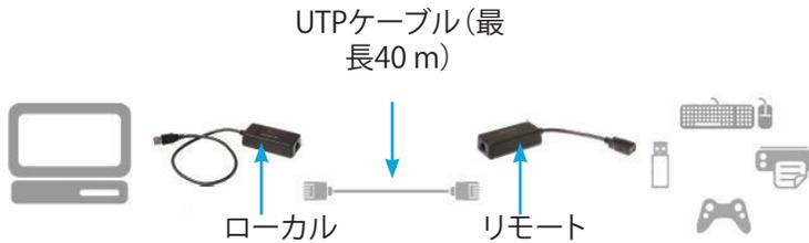
1. エクステンダのローカル機とリモート機を希望する場所に置き、先に準備しておいたRJ45ターミネートドCat5/6ケーブルで接続します(「設置場所の準備をする」をご覧ください)。
