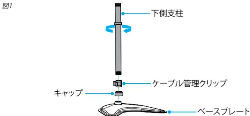
4. 3 mm六角レンチを使ってネジを締め、支柱をベースプレートに取り付けます。
