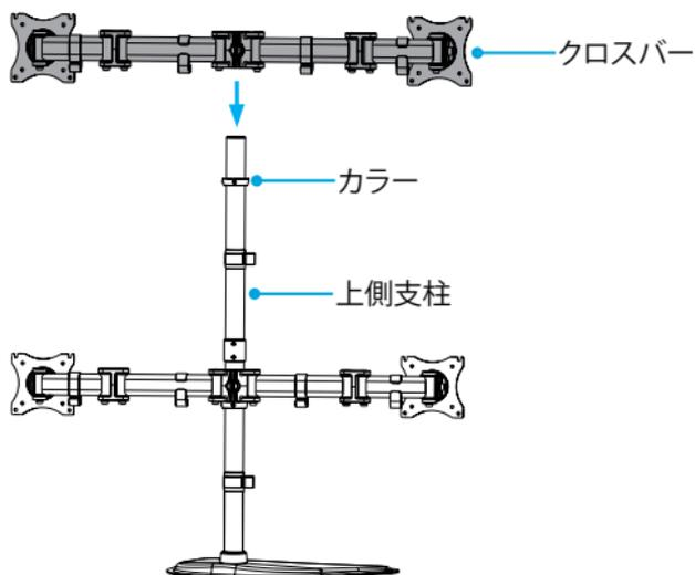
4. クロスバーの背面にあるネジを5 mm六角レンチを使って締めます。(図10)
