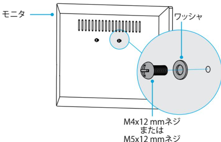
3. クロスバーのVESAモニタマウントの2つのスロットにネジを慎重に掛けます。(図12)
