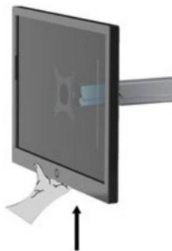
**注意:**下図に示す調整をする場合、ネジを時計回りに回すと抵抗が増し、反時計回りに回すと抵抗が減ります。
