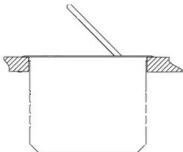
4. テーブル裏面で、ケーブルボックスの両側の各取付用金具を3つのうち1つの取付金具スロットに引っ掛けます。
