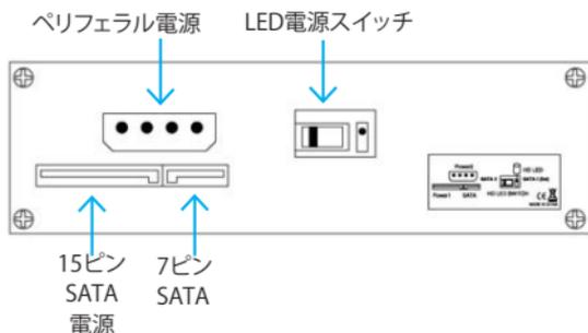
4. ベイを5.25インチベイスロットに挿入します。この際、ベイの側面または底部にあるネジ穴がベイスロットの穴と揃うようにします。
