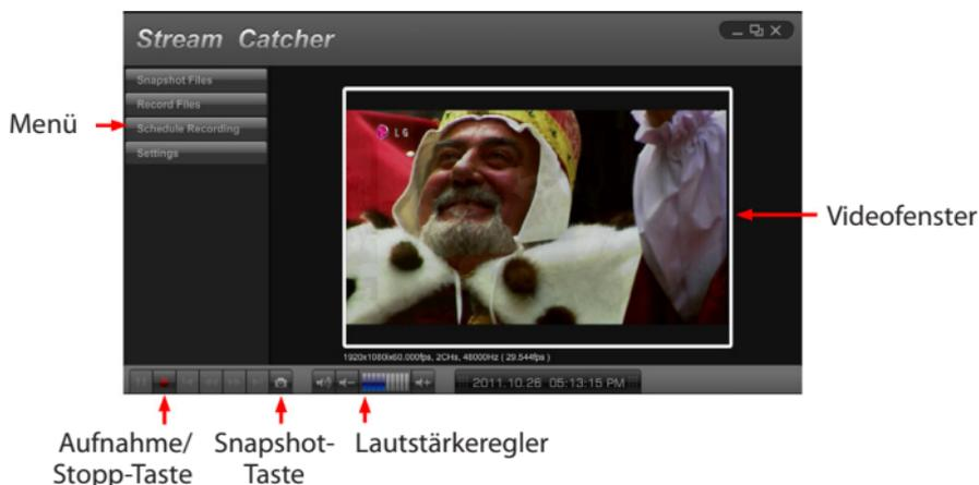
Manuelles Aufnehmen von Videos erfolgt einfach durch Drücken der "Aufnahme"-Taste in der Steuerung am unteren Rand des Stream-Catcher-Fensters. Während der Aufnahme wird der Rahmen um das Videofenster rot dargestellt. Wenn Sie die Aufnahme anhalten möchten, drücken Sie die "Stopp"-Taste. Die "Snapshot"-Taste ermöglicht es, ein Bild aus dem Video Stream aufzunehmen.
